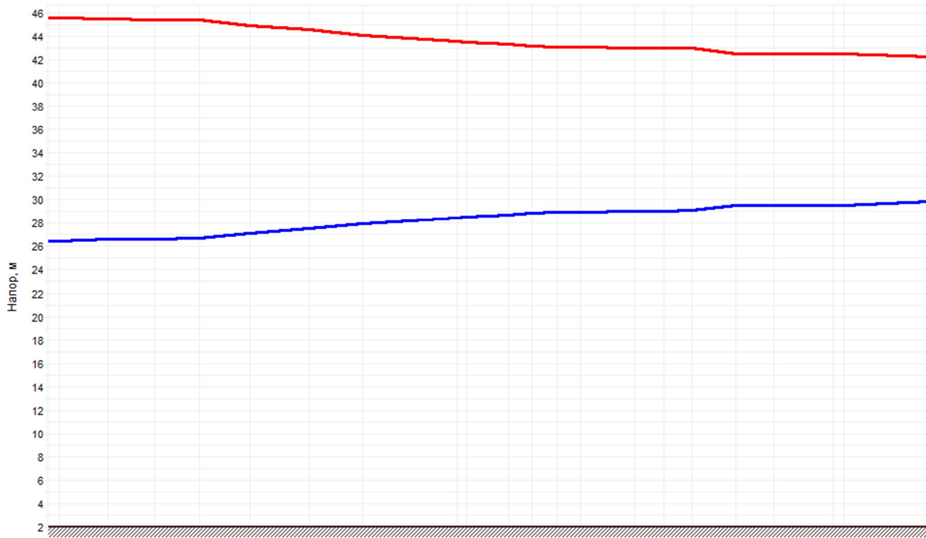
Рисунок 1.16 –График гидравлических режимов рассматриваемого теплопровода
