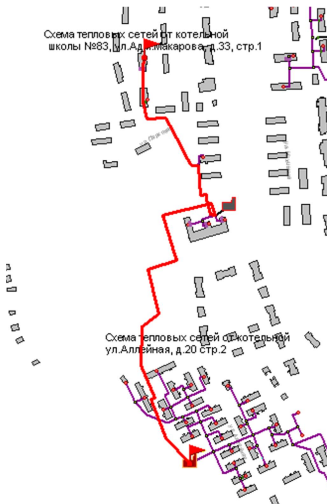
Рисунок 1.27 -Расчетный путь теплоносителя котельной до КИЗ «ЛУЧ»
