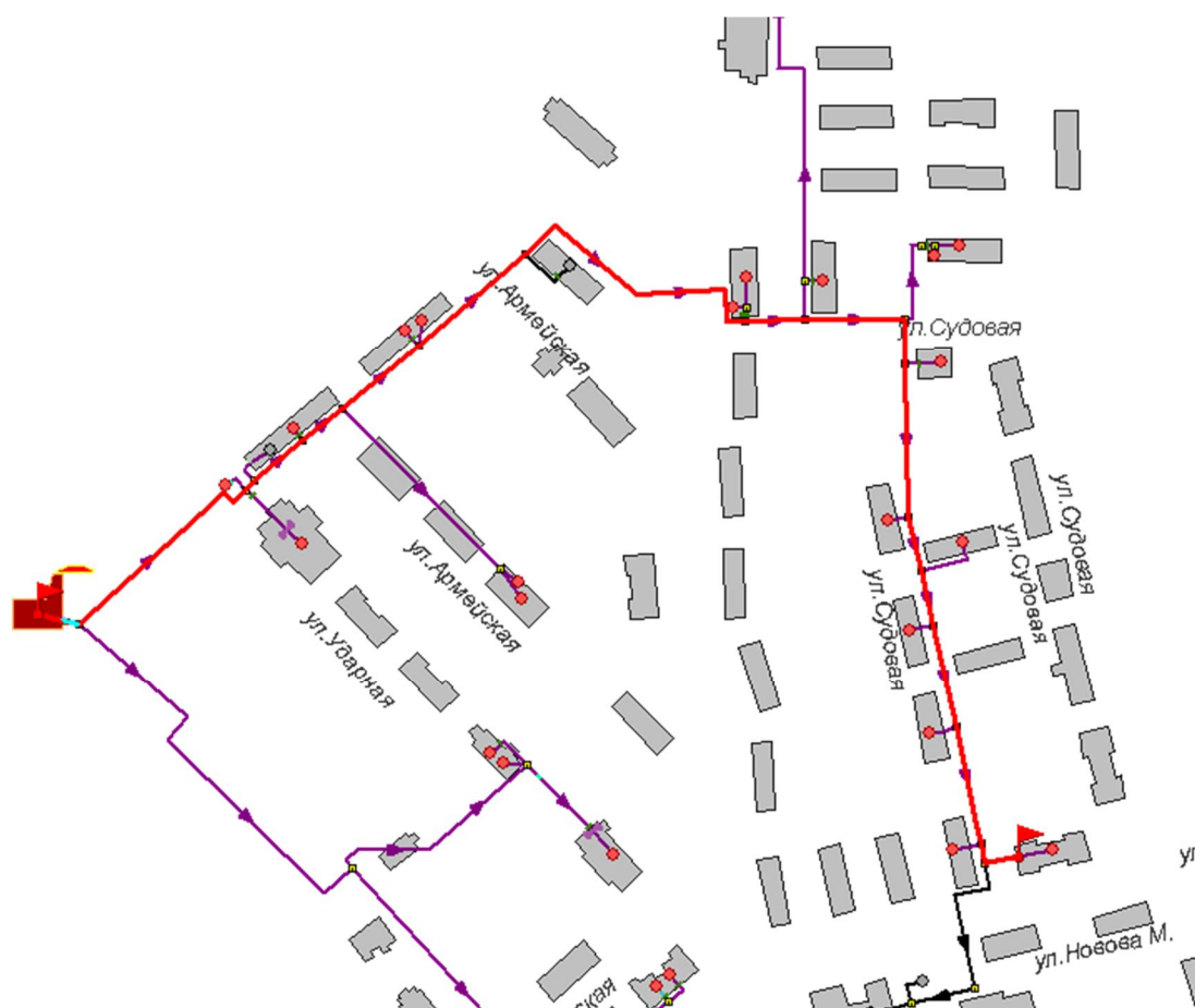
Рисунок 1.83 -Расчетный путь теплоносителя от котельной до Новова,17
