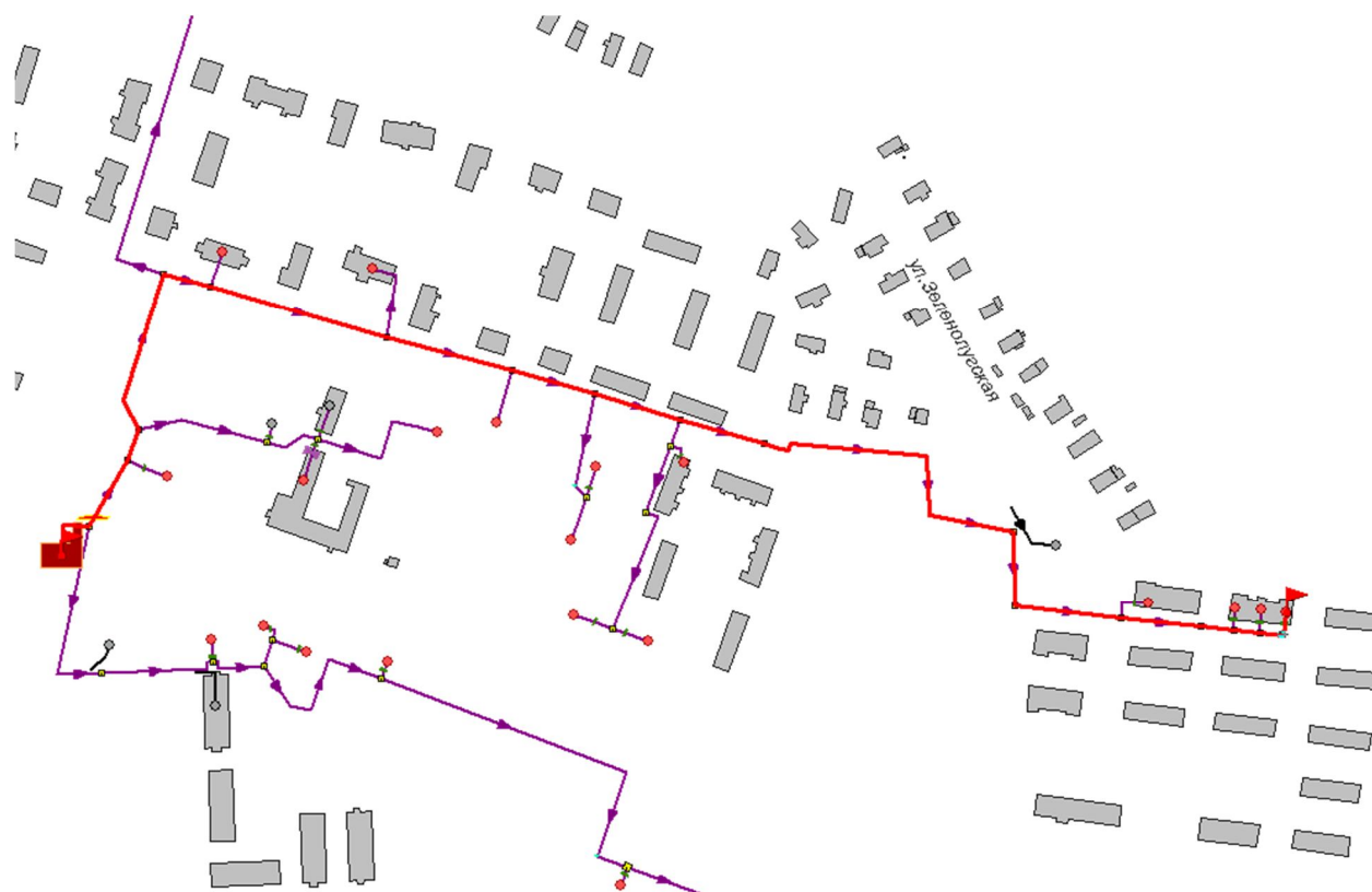
Рисунок 3.13 -Расчетный путь теплоносителя котельной до КЛДК 23, УУ1
