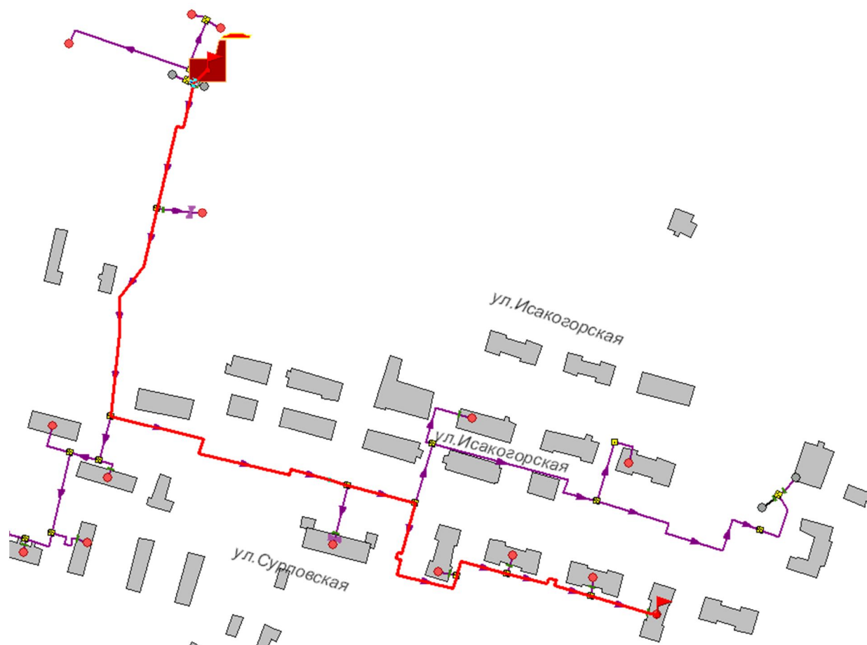
Рисунок 1.17 -Расчетный путь теплоносителя котельной до Сурповской, д. 20
