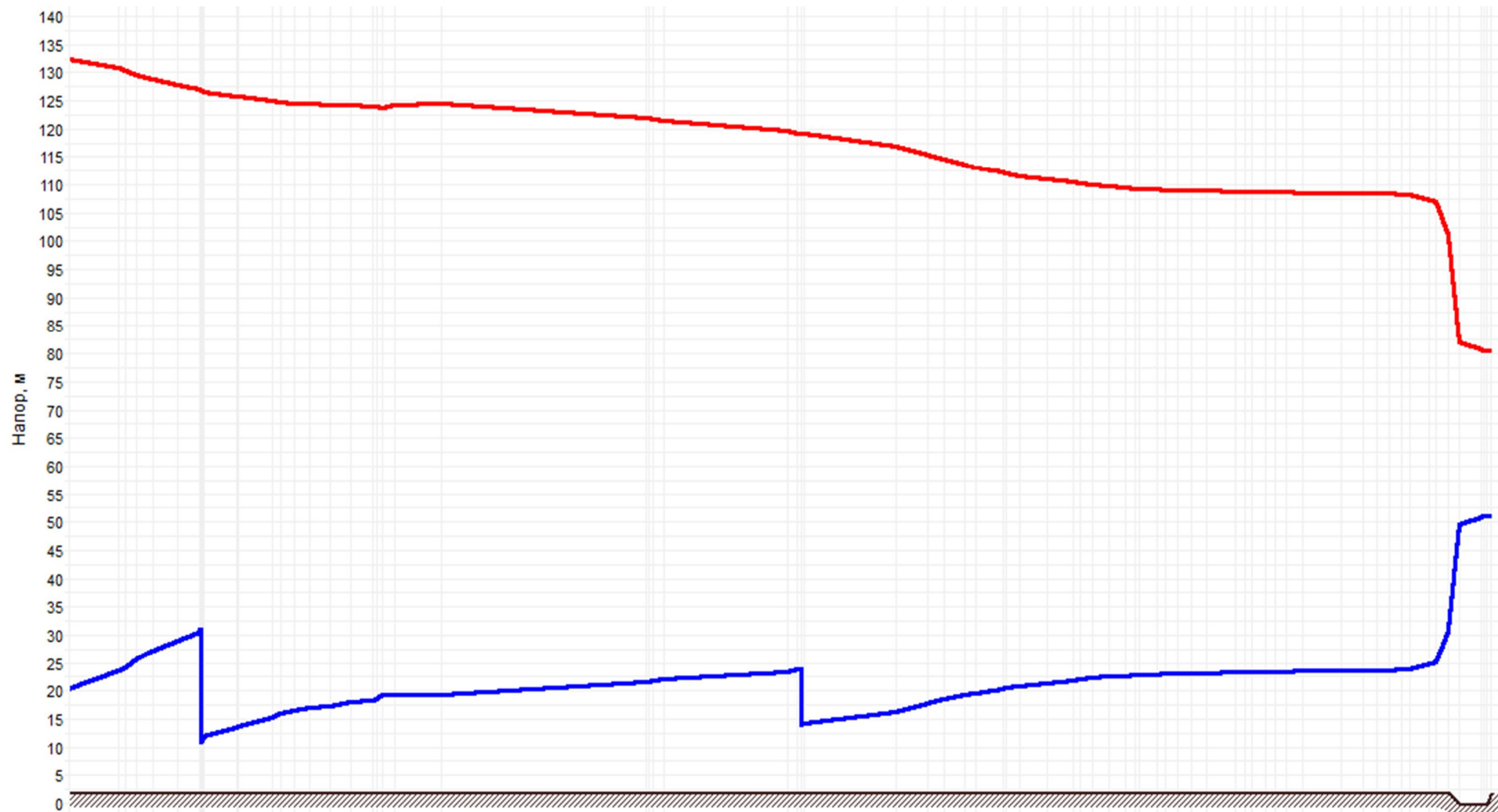
Рисунок 2.4 –График гидравлических режимов рассматриваемого теплопровода
