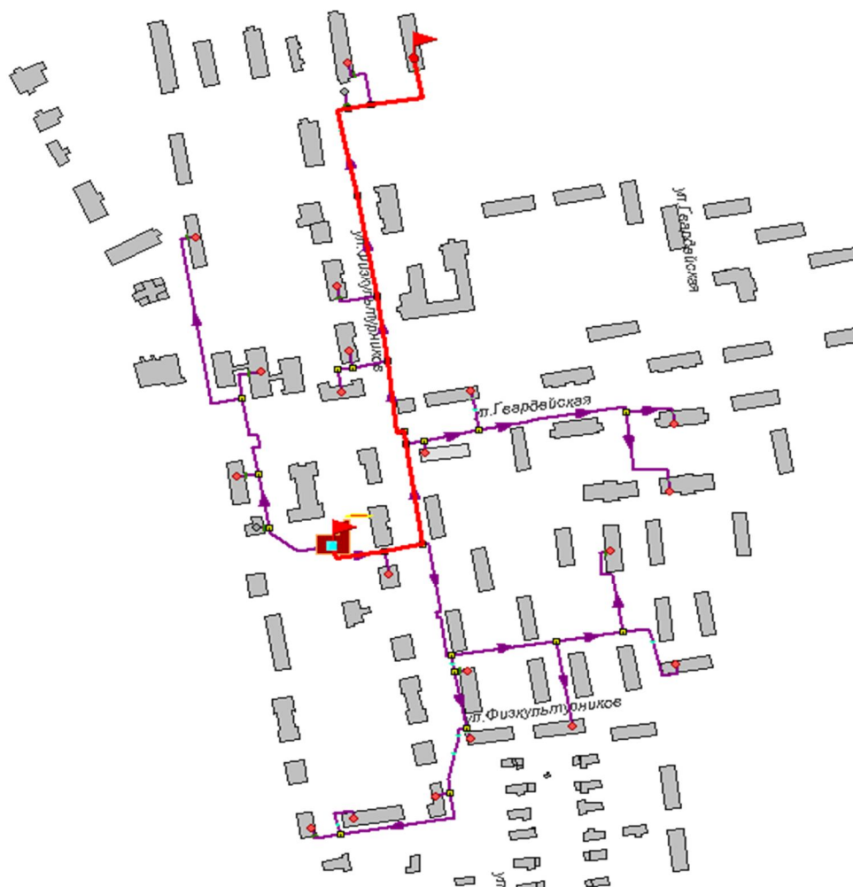
Рисунок 2.67 -Расчетный путь теплоносителя от котельной до Петрова,9
