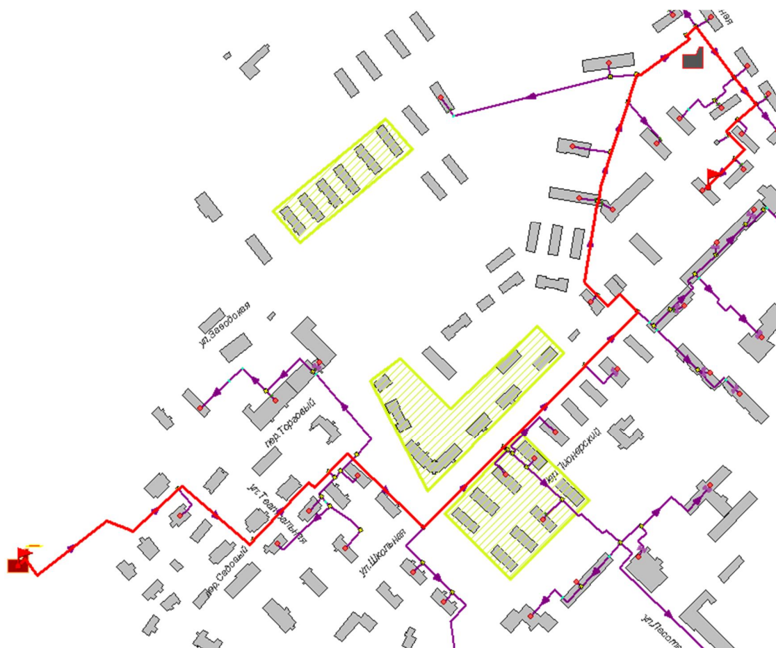
Рисунок 3.81 -Расчетный путь теплоносителя котельной до Школьная,162
