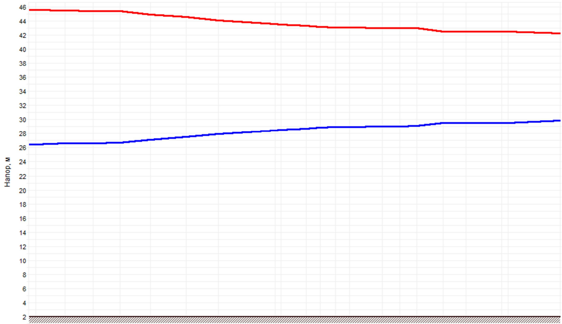
Рисунок 2.16 –График гидравлических режимов рассматриваемого теплопровода
