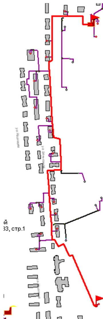
Рисунок 3.25 -Расчетный путь теплоносителя котельной до Пластмассового завода
