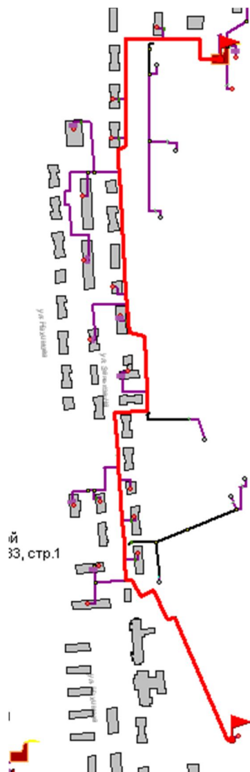
Рисунок 1.25 -Расчетный путь теплоносителя котельной до Пластмассового завода
