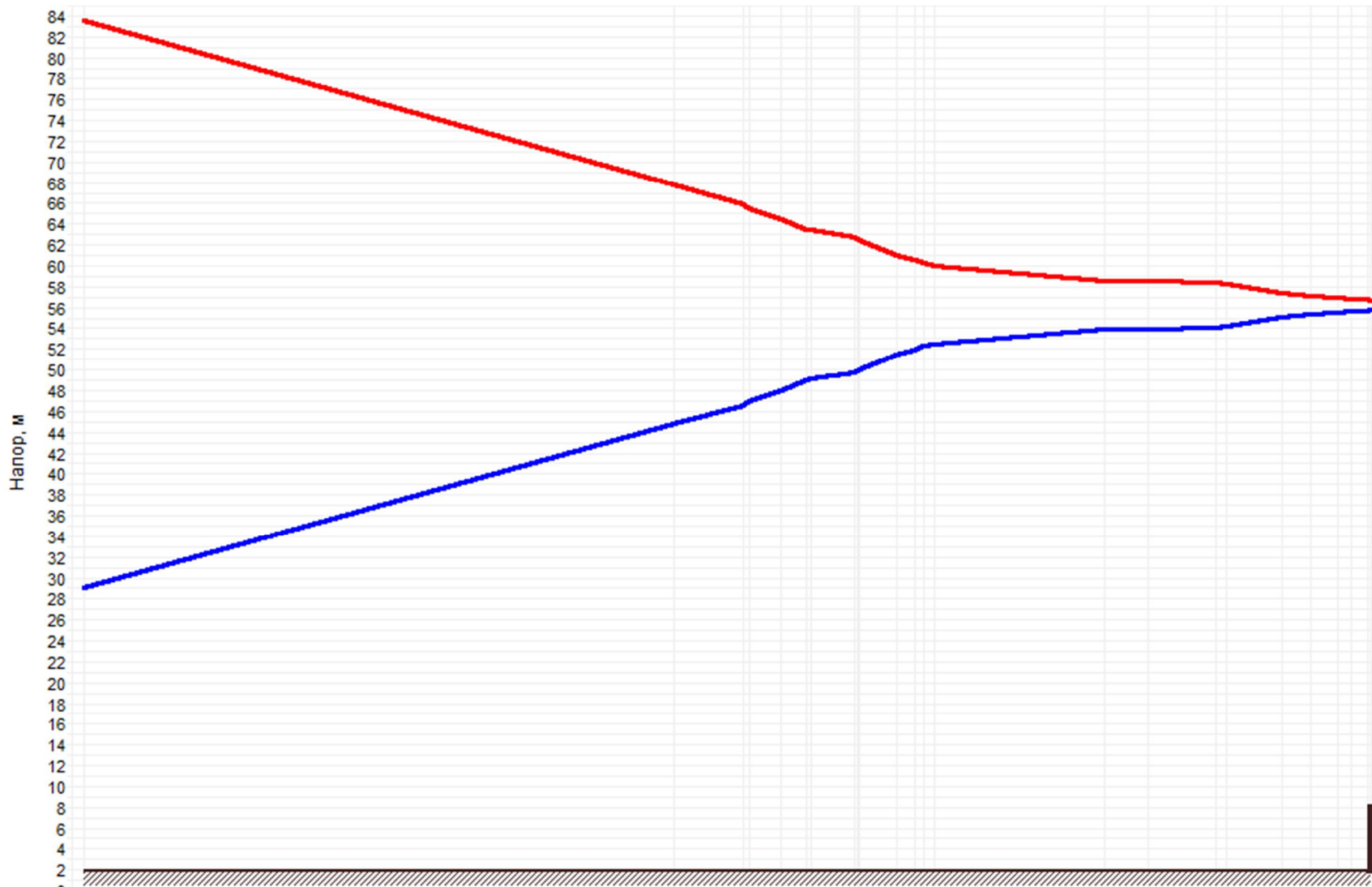
Рисунок 2.24 –График гидравлических режимов рассматриваемого теплопровода
