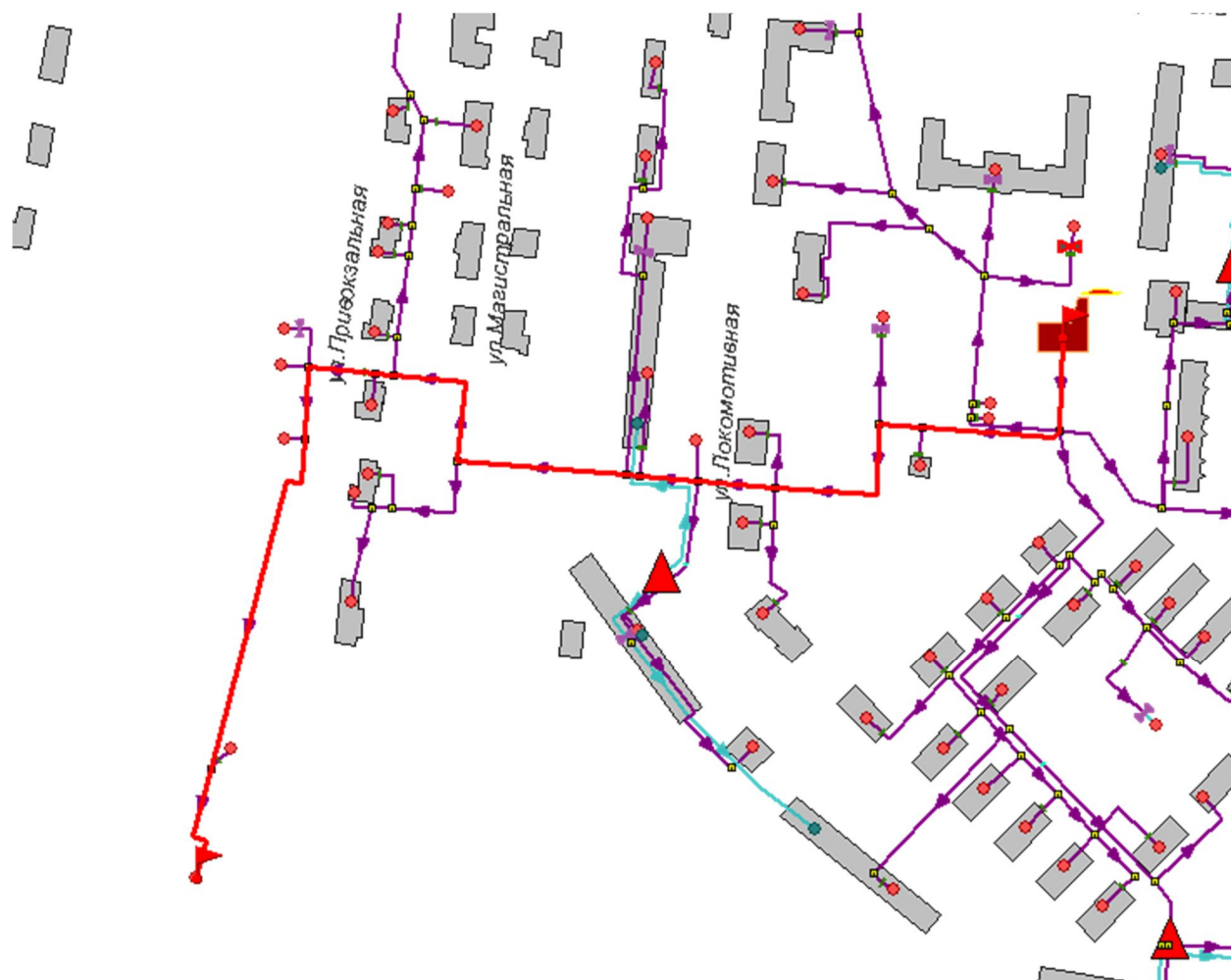
Рисунок 2.43 -Расчетный путь теплоносителя от котельной до Привокзальная, 19
