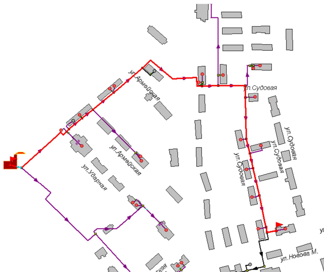
Рисунок 3.83 -Расчетный путь теплоносителя от котельной до Новова,17
