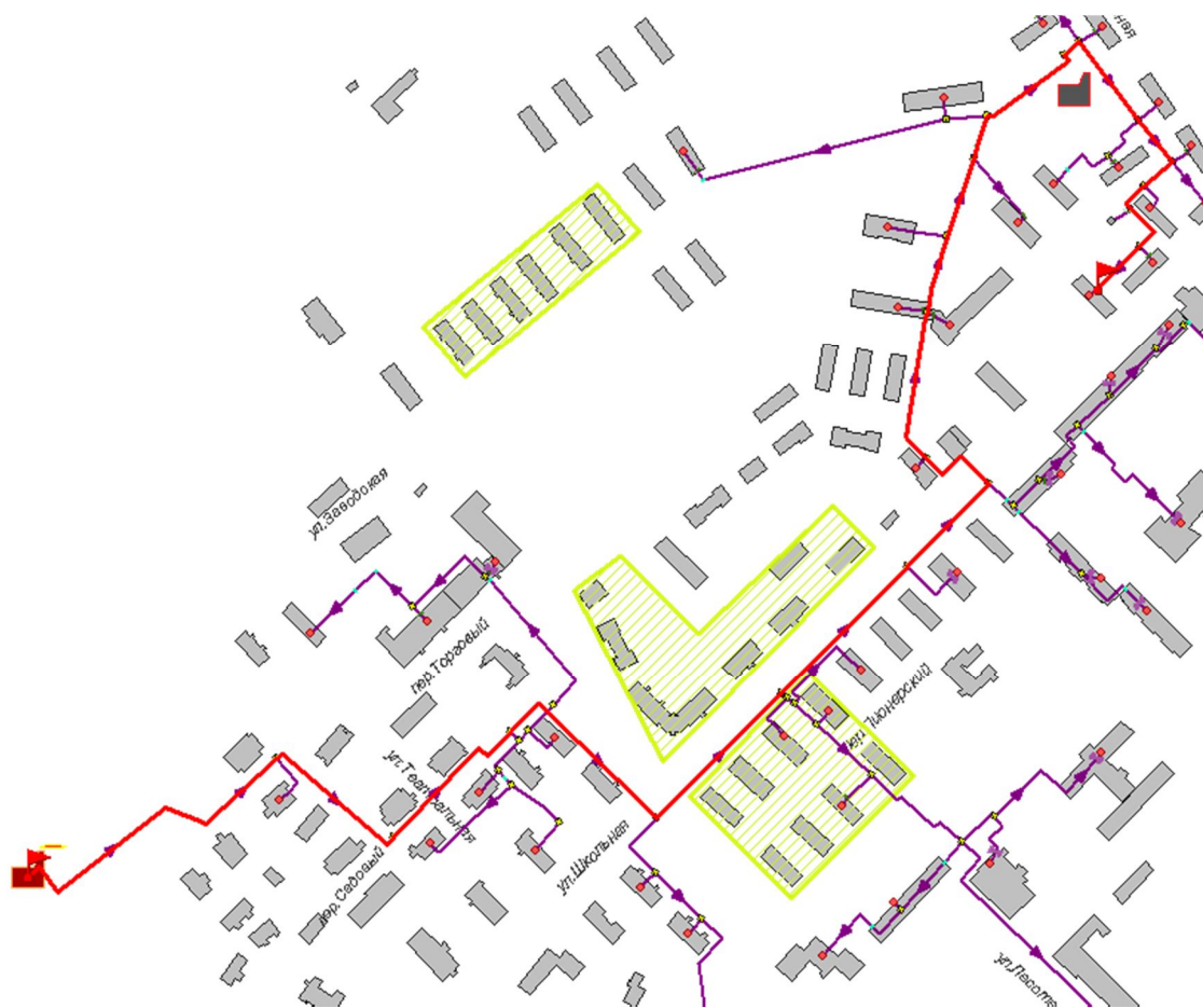
Рисунок 2.81 -Расчетный путь теплоносителя котельной до Школьная,162
