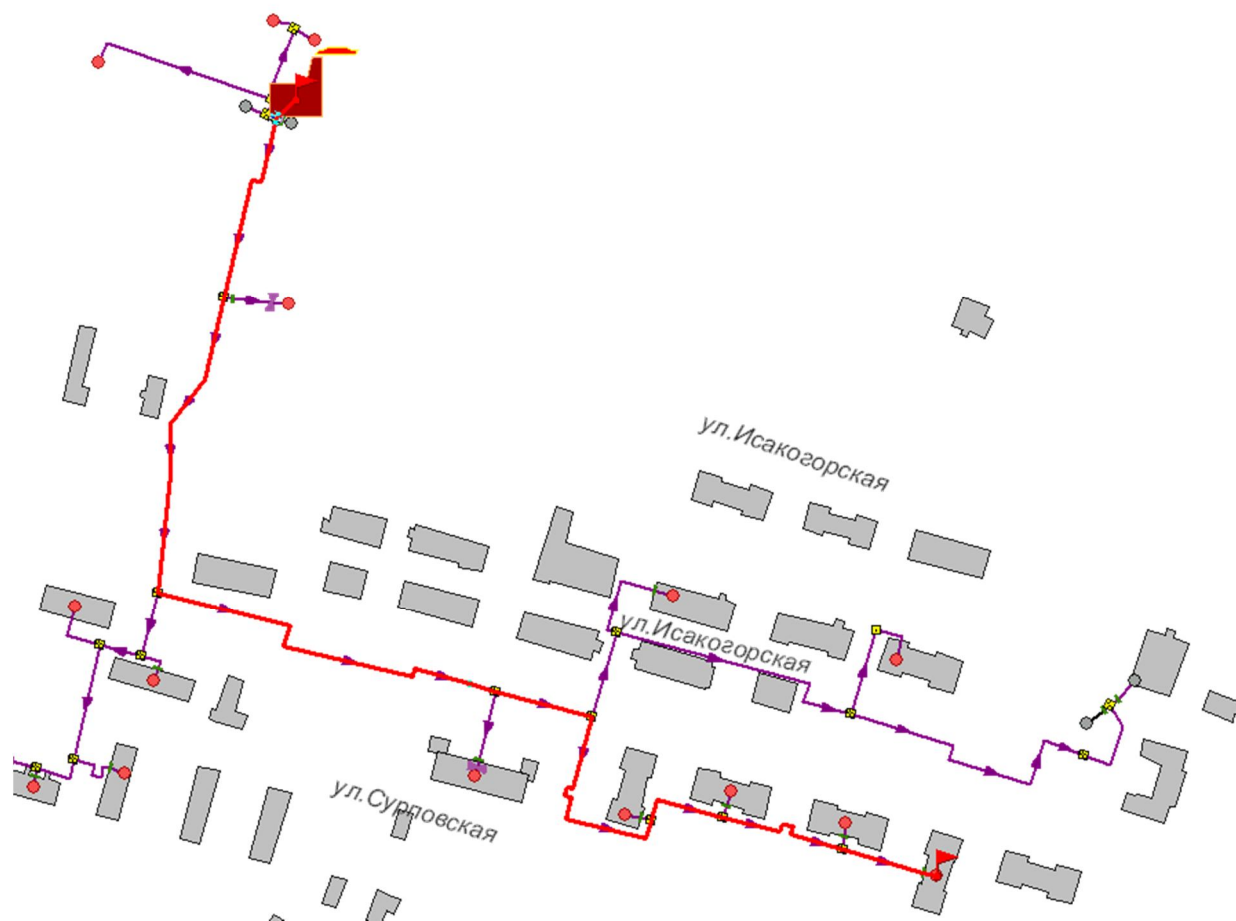
Рисунок 2.17 -Расчетный путь теплоносителя котельной до Сурповской, 20
