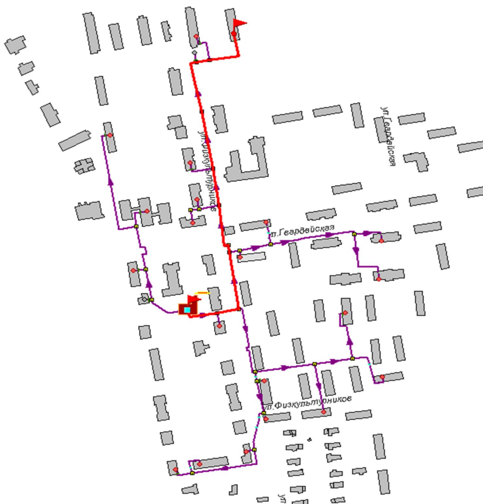
Рисунок 3.71 -Расчетный путь теплоносителя от котельной до Петрова,9
