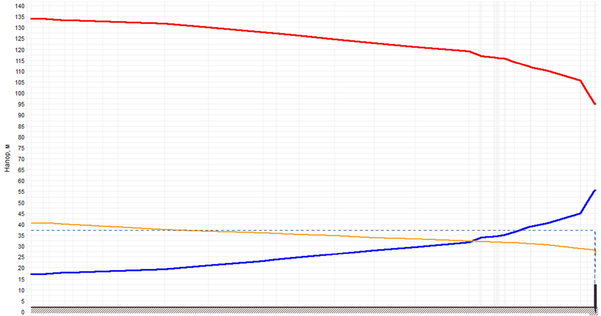
Рисунок 1.8 –График гидравлических режимов рассматриваемого теплопровода
