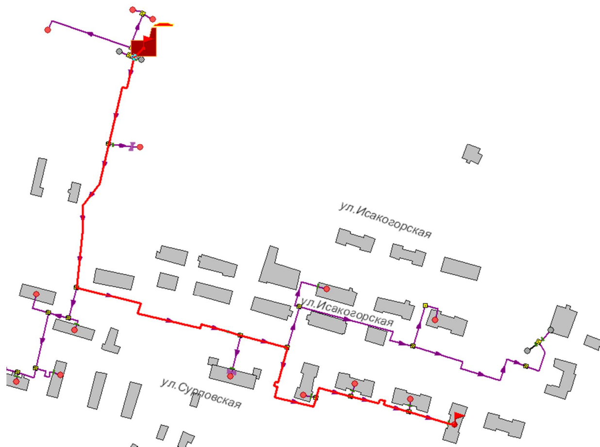
Рисунок 1.17 -Расчетный путь теплоносителя котельной до Сурповской, 20
