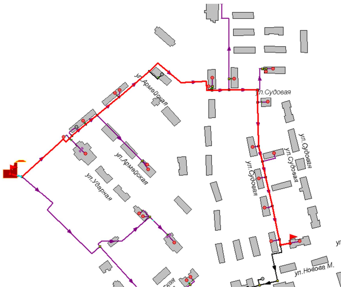
Рисунок 2.87 -Расчетный путь теплоносителя от котельной до Новова,17
