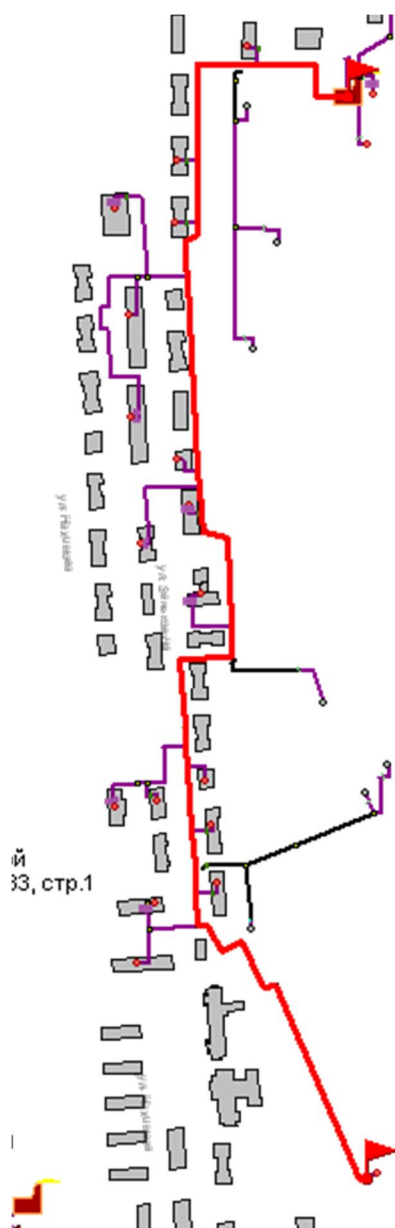
Рисунок 1.29 -Расчетный путь теплоносителя котельной до Пластмассового завода
