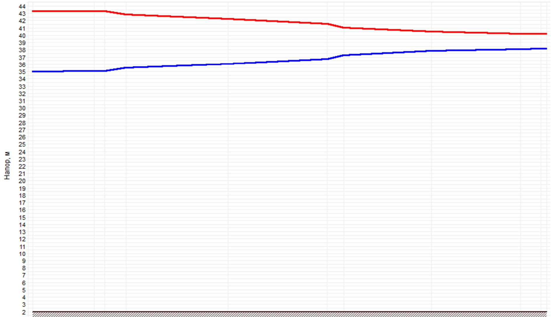
Рисунок 1.52 –График гидравлических режимов рассматриваемого теплопровода
