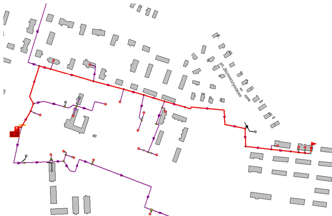
Рисунок 3.13 -Расчетный путь теплоносителя котельной до КЛДК 23, УУ1
