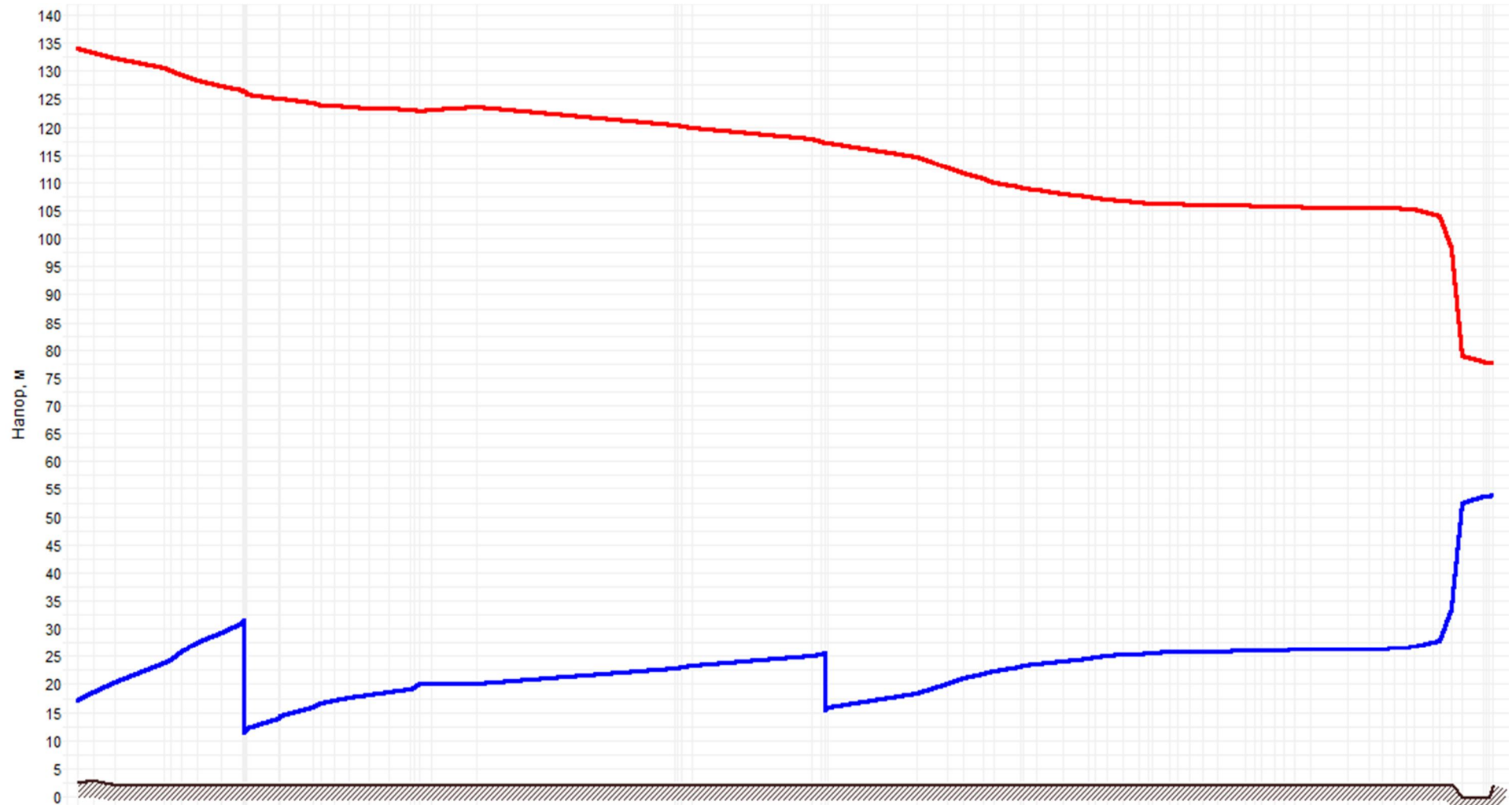
Рисунок 3.4 –График гидравлических режимов рассматриваемого теплопровода
