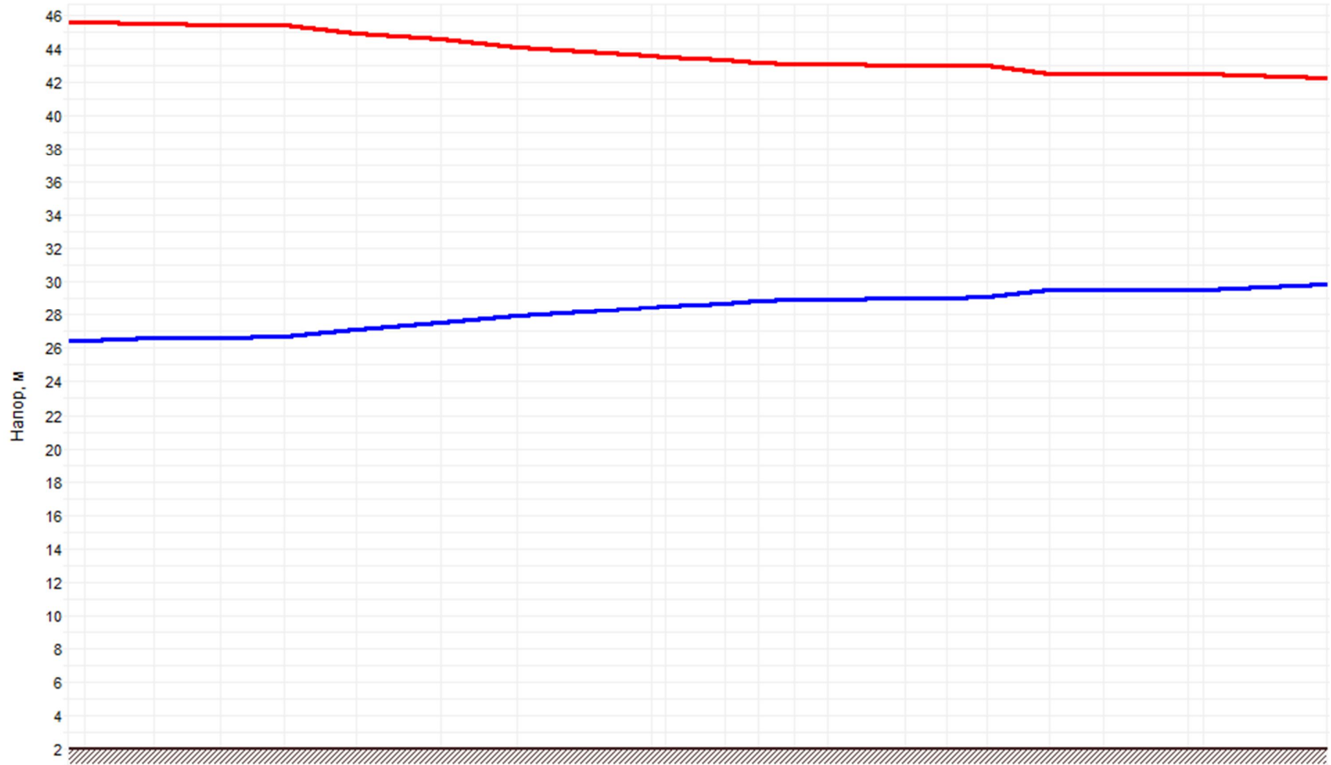
Рисунок 1.16 –График гидравлических режимов рассматриваемого теплопровода
