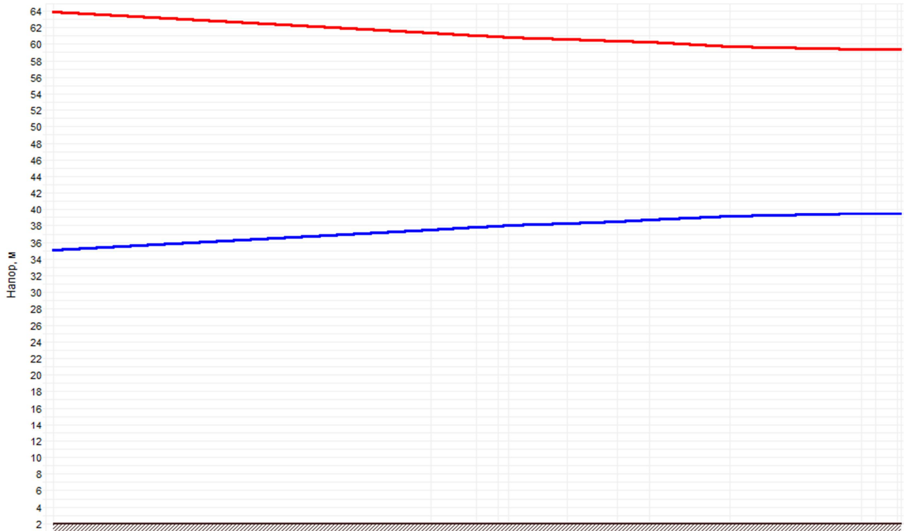
Рисунок 1.36 –График гидравлических режимов рассматриваемого теплопровода
