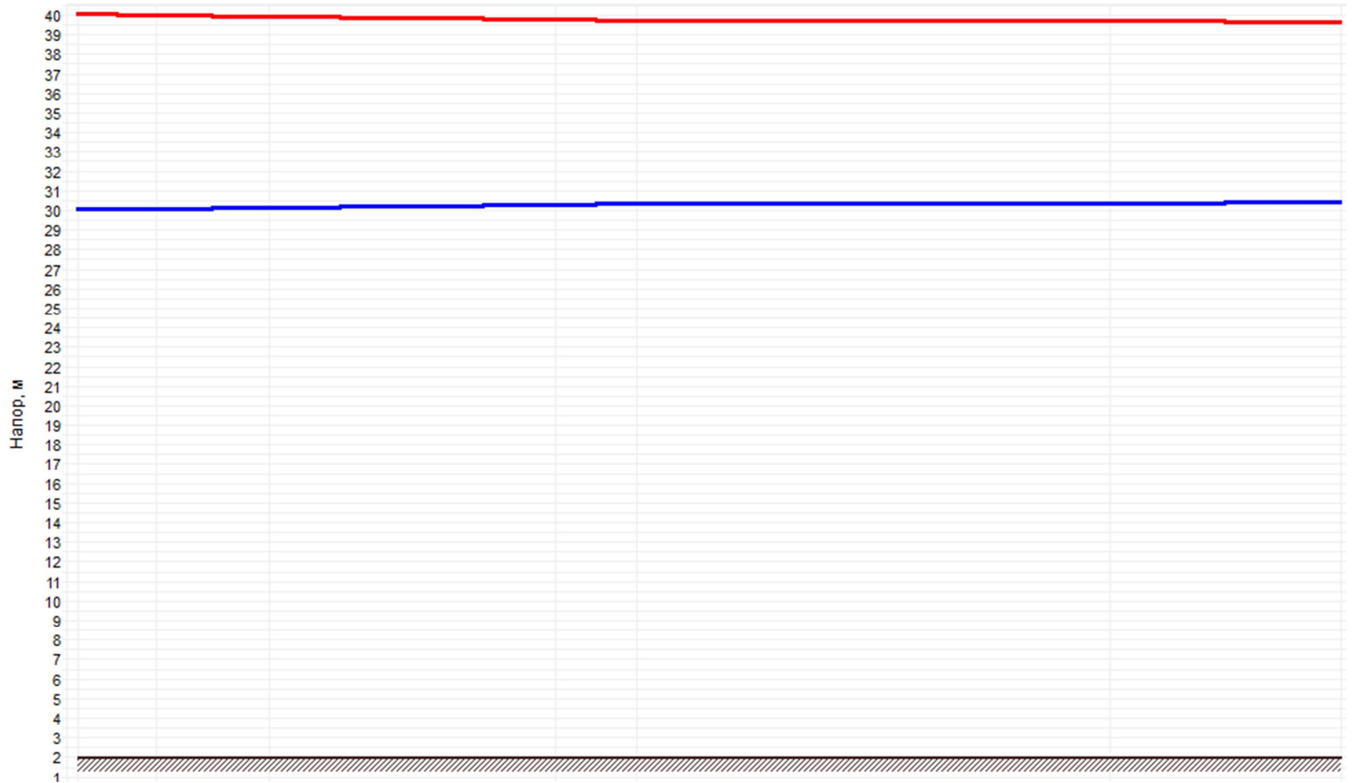
Рисунок 1.20 –График гидравлических режимов рассматриваемого теплопровода
