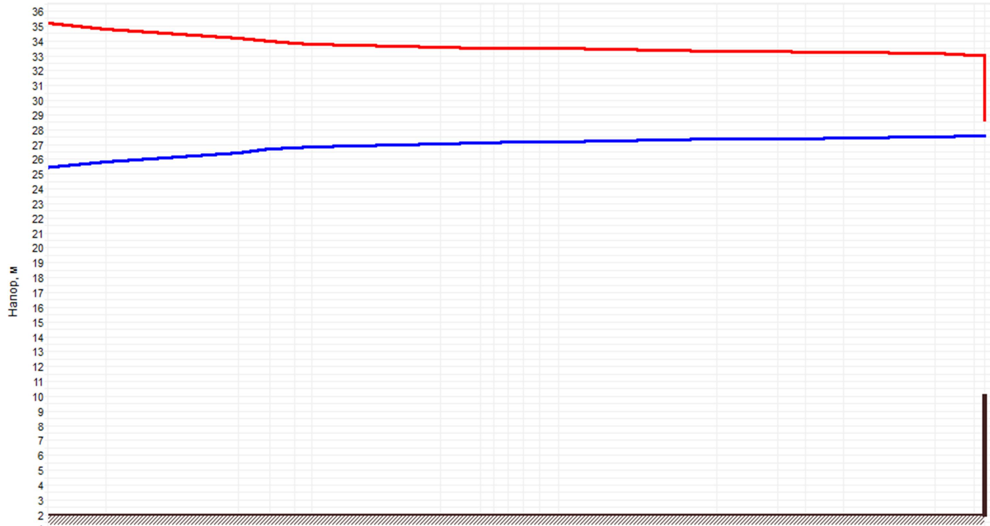
Рисунок 1.66 –График гидравлических режимов рассматриваемого теплопровода
