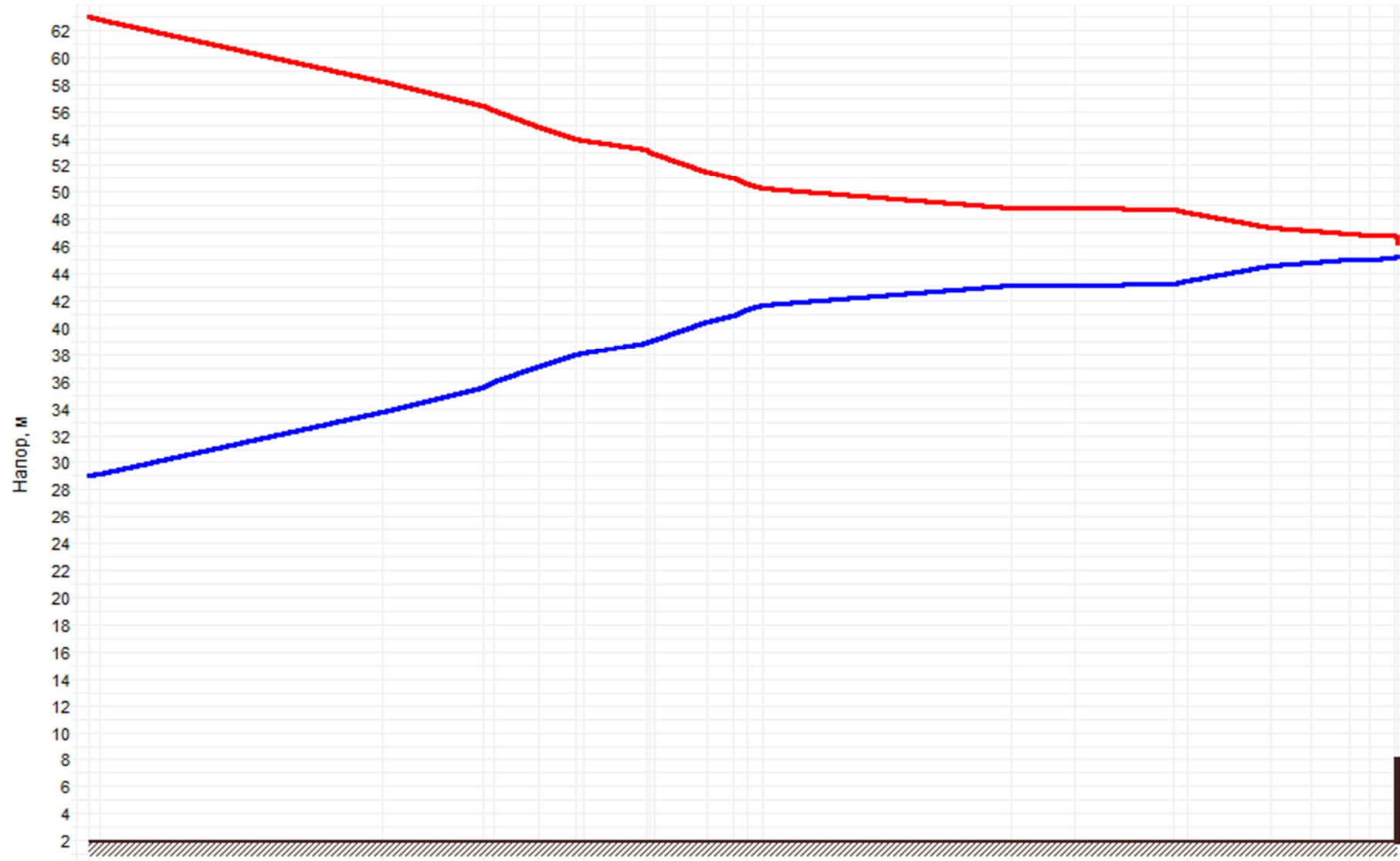
Рисунок 1.28 –График гидравлических режимов рассматриваемого теплопровода
