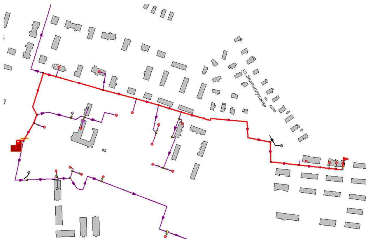
Рисунок 1.13 -Расчетный путь теплоносителя котельной до КЛДК 23, УУ1
