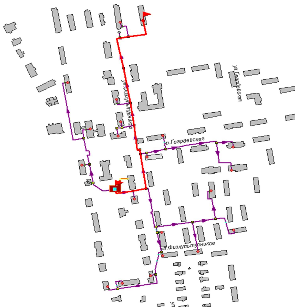
Рисунок 1.71 -Расчетный путь теплоносителя от котельной до Петрова,9
