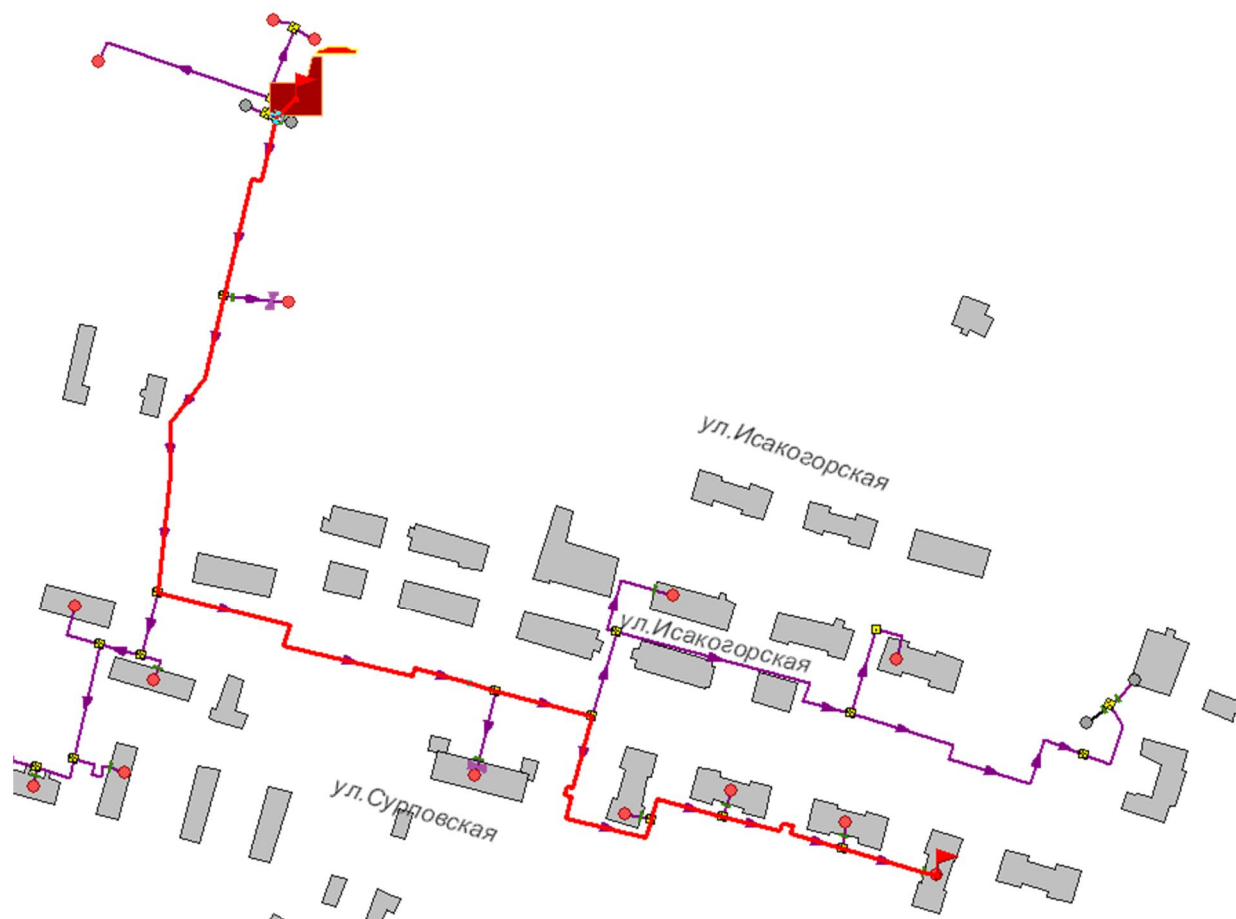
Рисунок 2.17 -Расчетный путь теплоносителя котельной до Сурповской, 20
