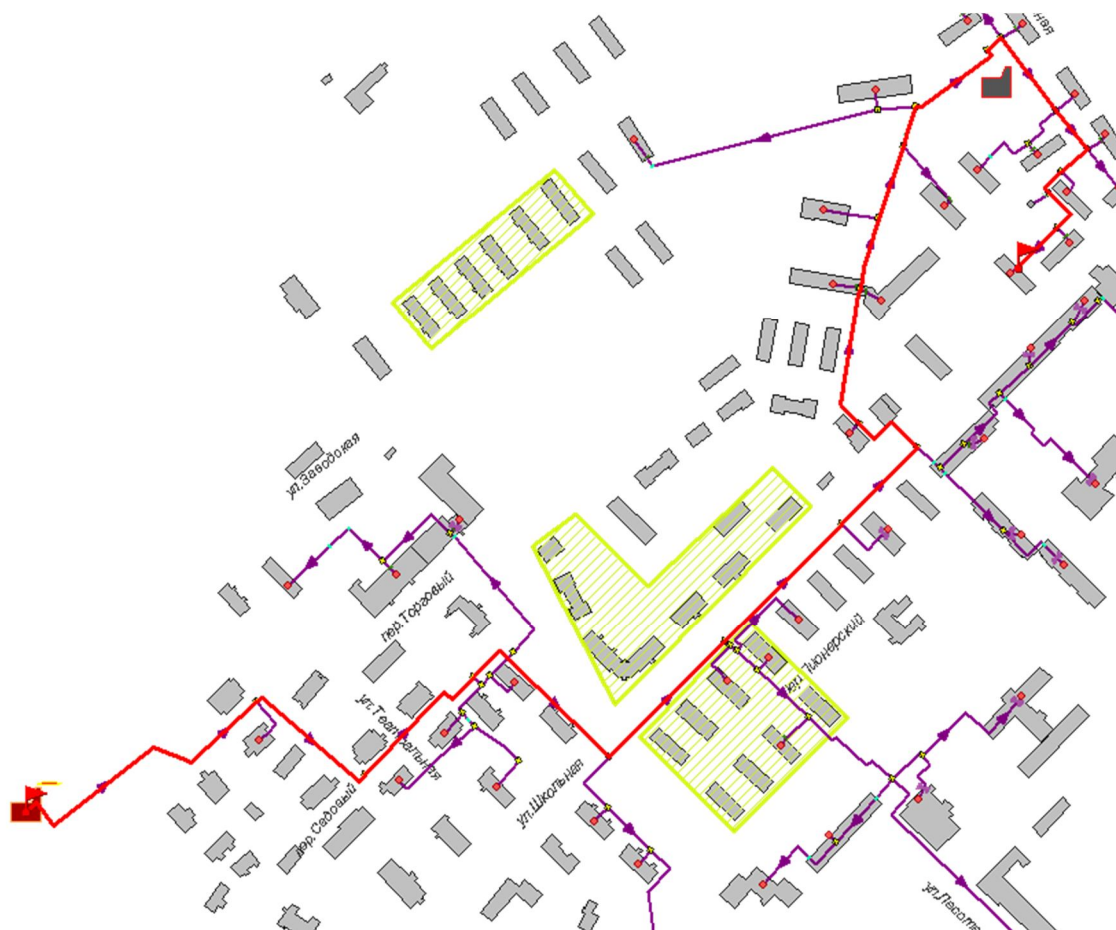
Рисунок 3.85 -Расчетный путь теплоносителя котельной до Школьная,162
