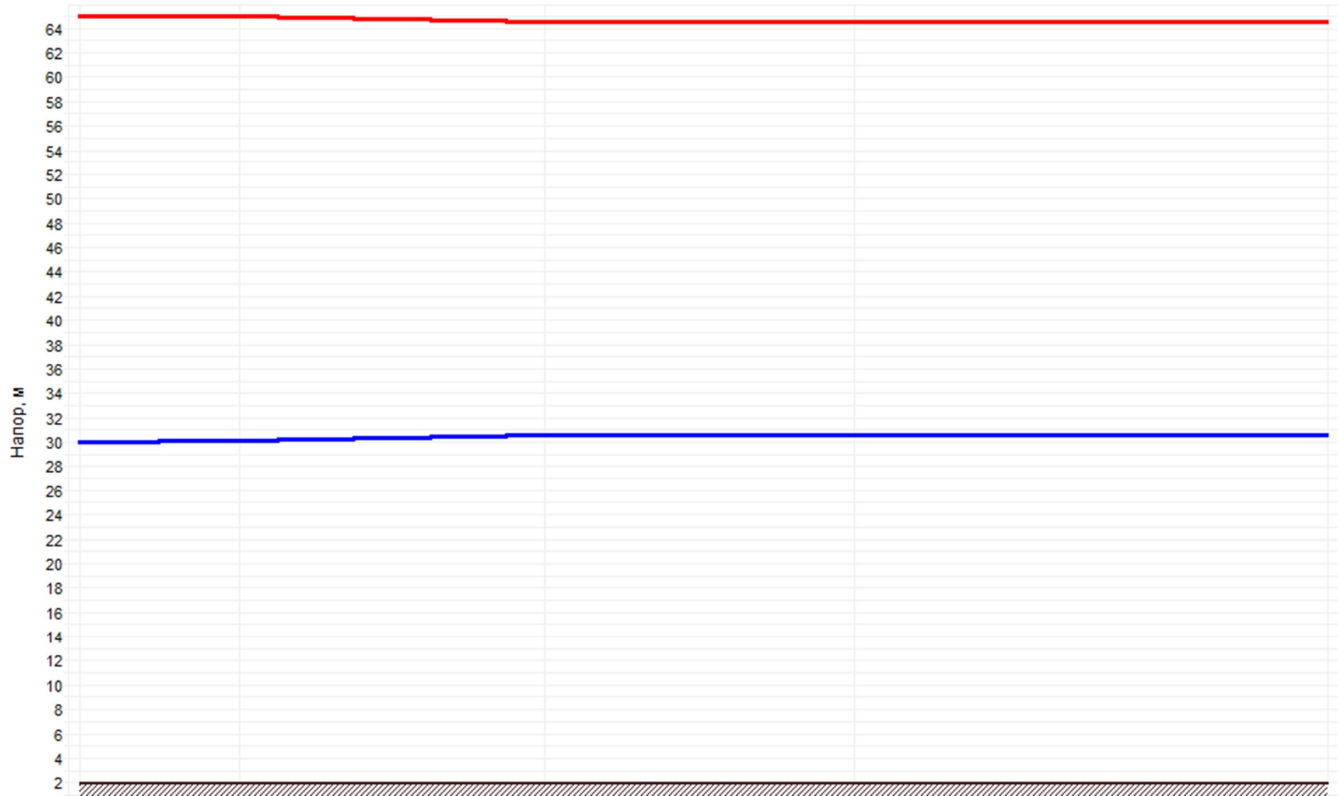
Рисунок 2.22 –График гидравлических режимов рассматриваемого теплопровода
