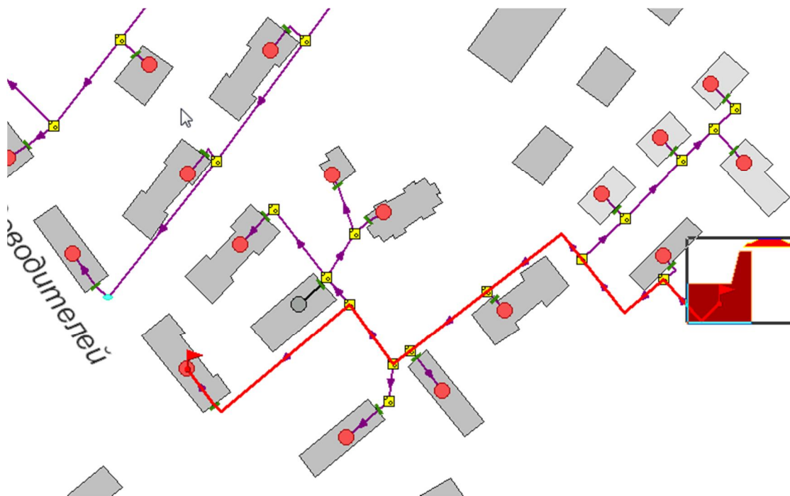
Рисунок 1.43 -Расчетный путь теплоносителя котельной до Речников,29
