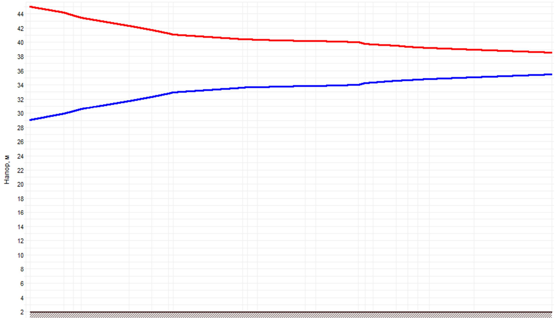
Рисунок 2.30 –График гидравлических режимов рассматриваемого теплопровода
