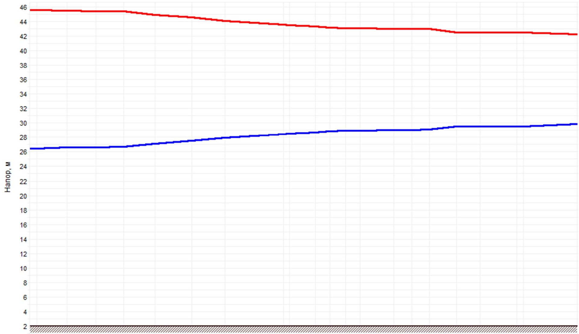
Рисунок 3.16 –График гидравлических режимов рассматриваемого теплопровода
