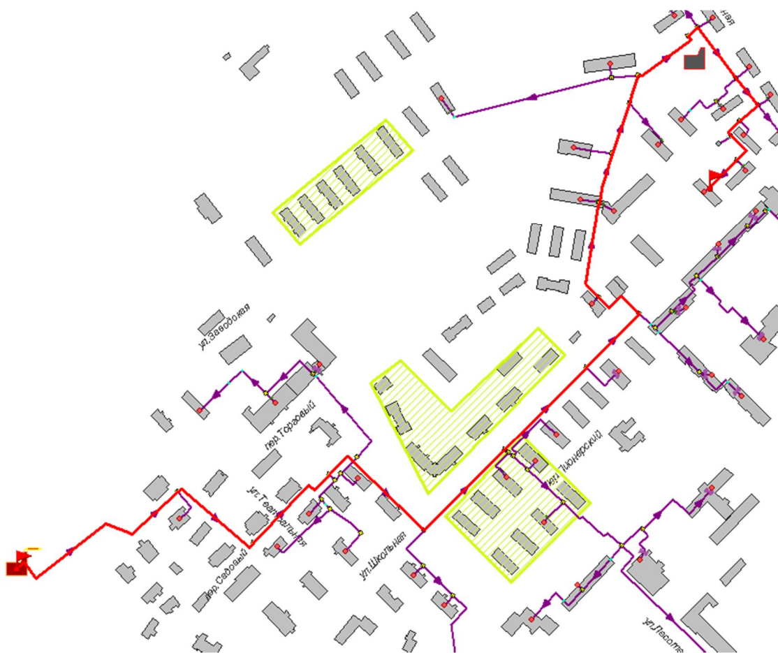
Рисунок 1.85 -Расчетный путь теплоносителя котельной до Школьная,162
