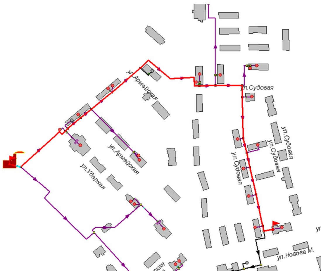
Рисунок 1.87 -Расчетный путь теплоносителя от котельной до Новова,17
