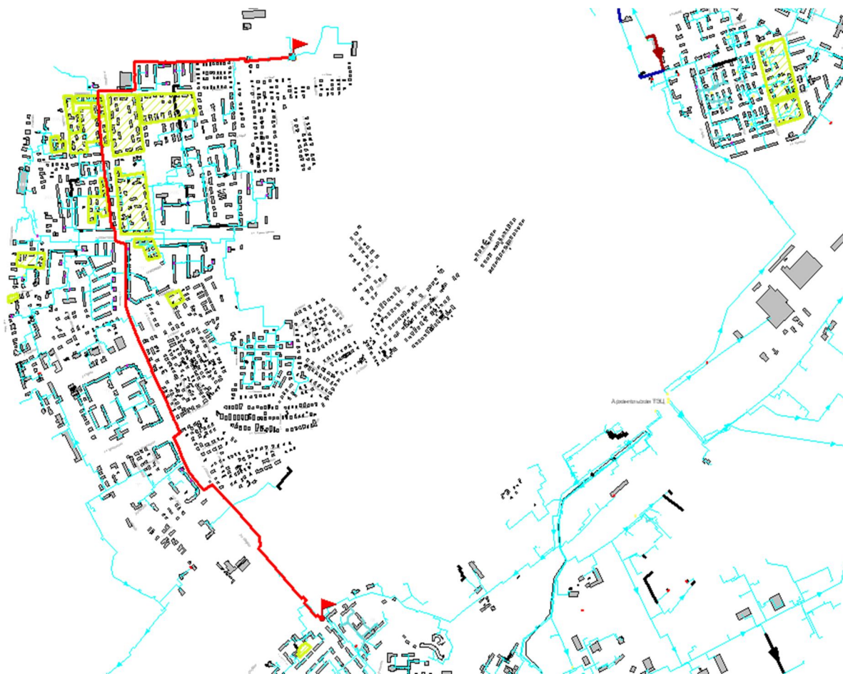
Рисунок 2.1 – Путь для расчёта вероятности безотказной работы тепловых сетей от ТК-45 до С-28п-16
